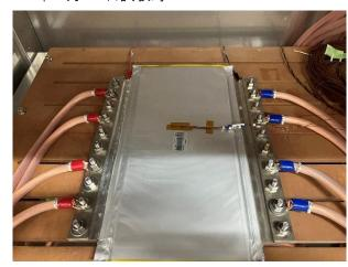
※充放電装置の電流線をセル端子部へ接続する際、3/26 の接続のようにタブに対して均等に配置することで充放電時の温度上昇が抑えられるとの指摘があり、3/26 の試験から接続位置を変更した。
